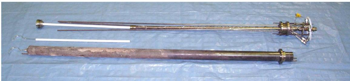
Abb 2: Foto der zerlegten Probenahme-Sonde mit keramischem Porous Tube Diluter
