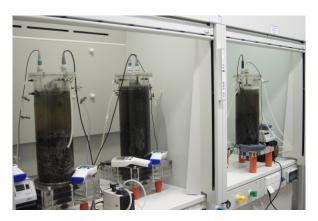
Abb.6: Die drei während des Versuches zum Einfluss der Sandbettumwälzung eingesetzten Bioreaktoren in Betrieb
