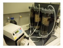
Abb.9: Festbettsäulen während der Befüllung (links) und vollständig befüllt in Betrieb (rechts)
