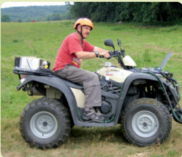
Abbildung 9: Erprobung neu entwickelter mobiler Messgeräte zur raschen Kartierung gasförmiger CO 2 -Austritte.
