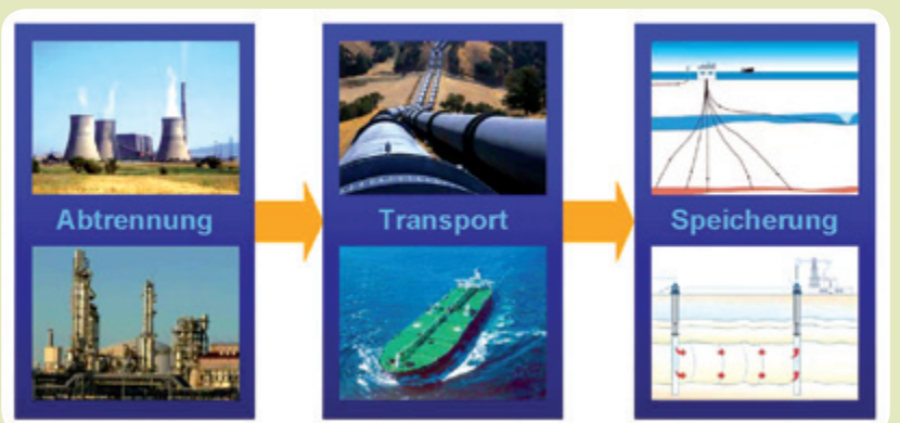
Abbildung 1: CCS – technische Prozesskette
