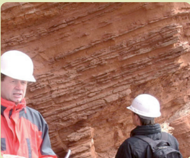
Abbildung 5: Komplexe Wechsellagerung grob- und feinsandiger Schichten in einem Oberflächenaufschluss von Buntsandstein, einem unter Norddeutschland weit verbreiteten Speichergestein.
