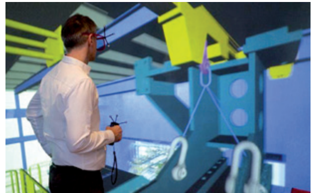
Abb. 4.3: Virtueller Abbau einer Altanlage und Aufbau einer Neuanlage auf Basis eines digitalen Zwillings: Verkürzung und Kostenreduktion durch Optimierung des Installationsablaufes, Verständnis des Ablaufs aller Parteien; Risikominimierung
